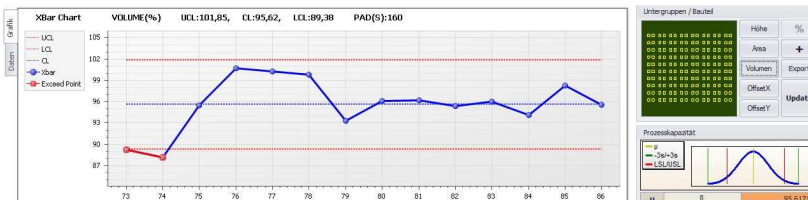
Öffnung 230 x 180 µm, Lotpaste T5, Schablone 80µm, Area Ratio 0,66
