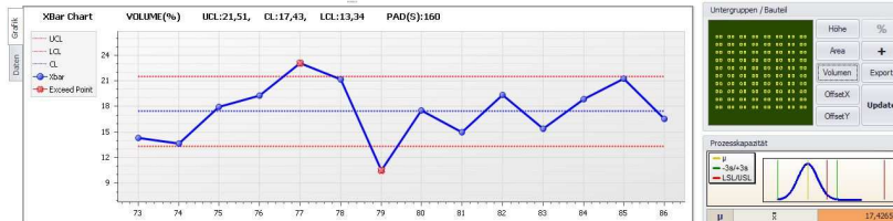
Öffnung 160 x 110 µm, Lotpaste T5, Schablone 80µm, Area Ratio 0,41
